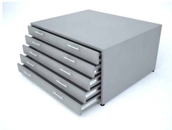
Planoteca horizontal de 5 gavetas: 75 cm de alto, 112 cm de ancho y 80 cm de fondo. Gavetas con pisa plano, porta rótulo, manijas metálicas y ruedas en poliuretano negro (no rayan el piso). Fabricada en lámina cold rolled calibre 22 con acabado en pintura electrostática color gris nube o negro. Para planos, impresos, pinturas, etc. de 100 x 70 cm.
